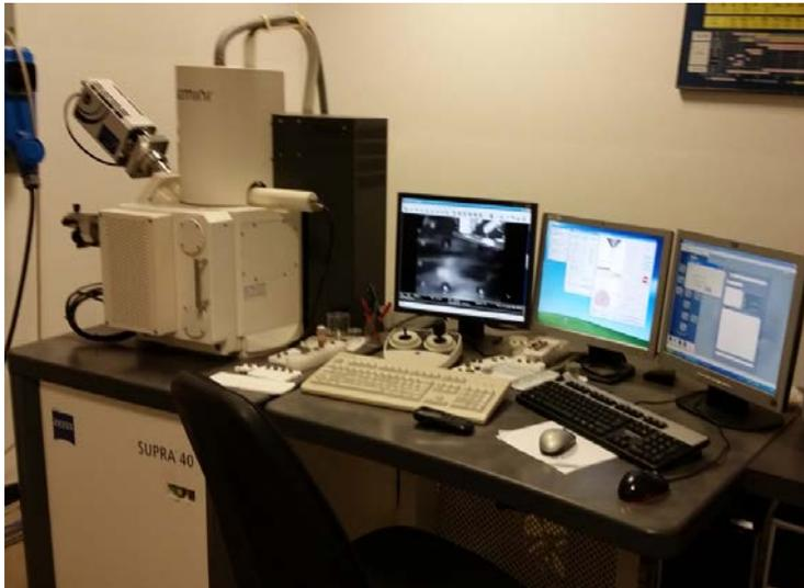
\* **elettroni secondari (SE)**, sono gli elettroni in origine legati ai livelli atomici più esterni, che ricevono dal fascio incidente un'energia addizionale sufficiente ad allontanarli. Hanno un'energia compresa tra 0 e 50 eV e sono emessi da spessori superficiali del campione (~10nm). Sono frequentemente utilizzati per lo studio della morfologia superficiale.
