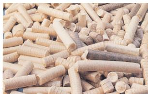
Le **Briquettes** (bricchetti) sono dei cilindri di qualche centimetro ottenuti pressando vari residui legnosi anche grandi (fino a 15 cm). Vengono prodotti come i pellets dalla segatura, in due diverse forme "tronchetti" e "mattoni" per una migliore gestione nell'uso e nello stoccaggio. Sono adatti per impianti che devono riscaldare grandi quantità volumetriche.
