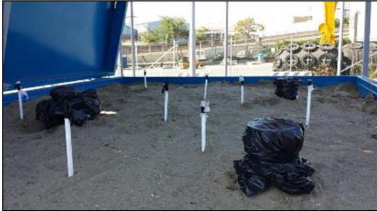
Pozzetti tubati in PTFE per monitoraggio temperature
