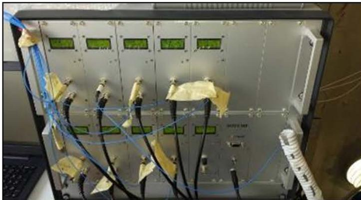
Termometro a fibra ottica a rack multicanale con uscita analogica 0-10 Vdc
